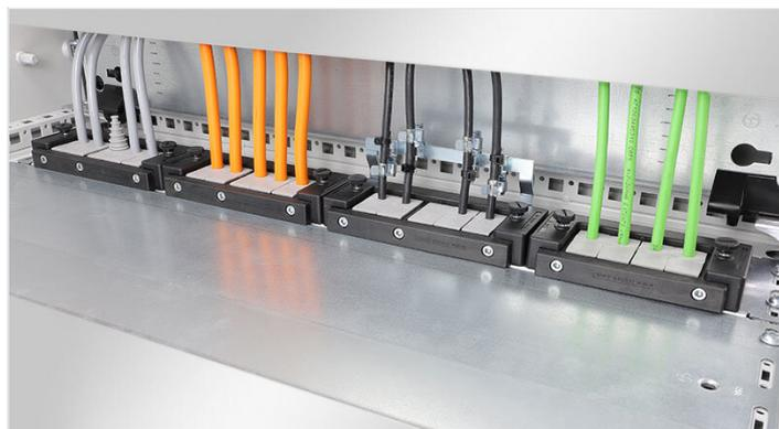
La plaque de fond KDR-ESR est une plaque de fond monobloc installée sur le bas de l'armoire électrique. Y sont préinstallés d'origine des glissières dans lesquels les cadres passe-câbles KEL-U, après équipement, sont insérés et encliquetés d'une manière extrêmement simple.
